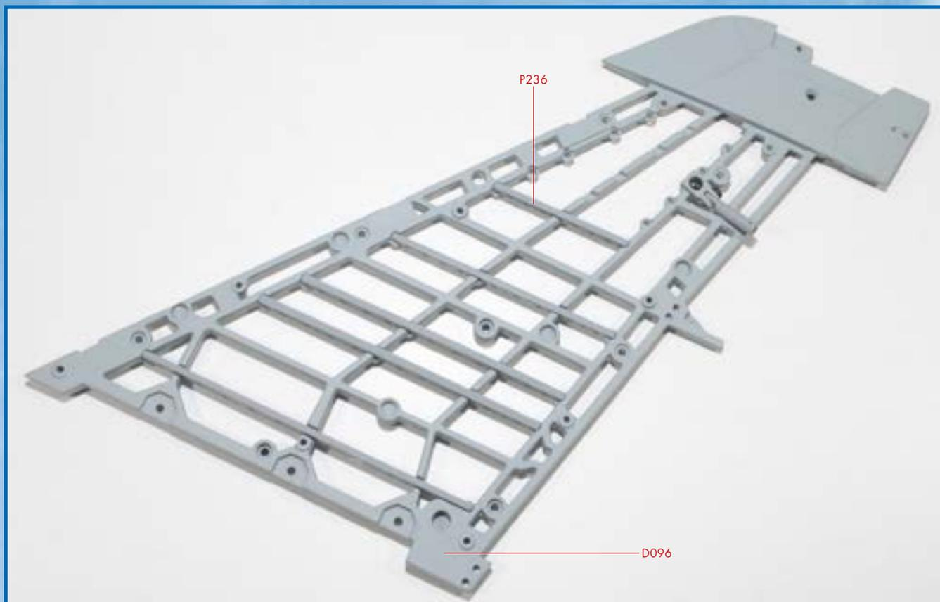
**2** Затем установите нервюру (P236) на каркас левой консоли крыла (D096), как показано на снимке.
